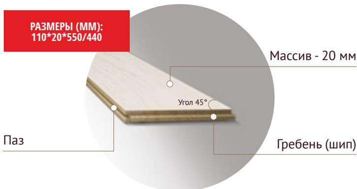
**„Французская ёлка“** – набор из калиброванных паркетных планок одинаковой длины с гребнями и пазами на противоположных сторонах. Угол запила планок – 45°, угол расположения планок при укладке – 90°. Планки изготавливаются парами (правой и левой). На планках выполнены фаски по периметру.
