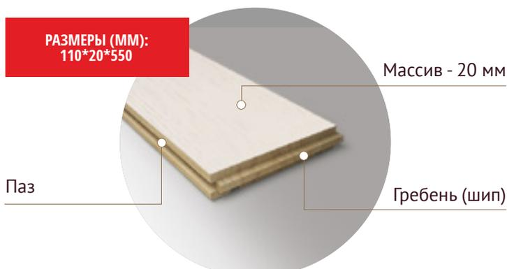
**„Венгерская ёлка“** - штучный паркет из массива - планки изготовлены из цельного массива дерева (дуб), с расположенными на кромках пазами и гребнями, предназначенными для соединения паркетных планок между собой. На планках выполнены фаски по всему периметру доски. Планки изготавливаются парами (правой и левой).
